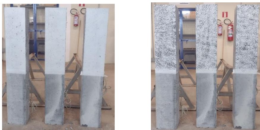
Figura 39. Preparação das superfícies das vigas para CID
