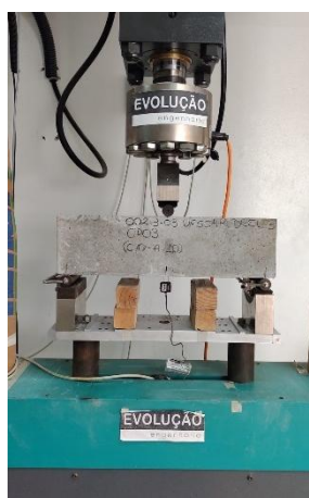
Figura 26. Ensaio de resistência à tração na flexão
