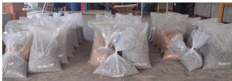
Figura 19. Separação dos materiais utilizados na produção dos concretos
