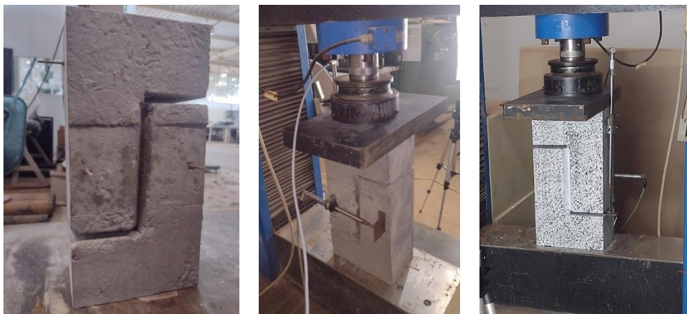
Figura 33. Instrumentação dos corpos de prova para o ensaio de cisalhamento do tipo Push-off
