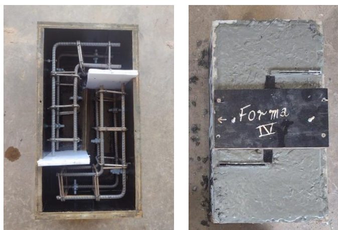
Figura 32. Fôrma preparada e corpo de prova moldado para ensaio de cisalhamento do tipo Push-off
