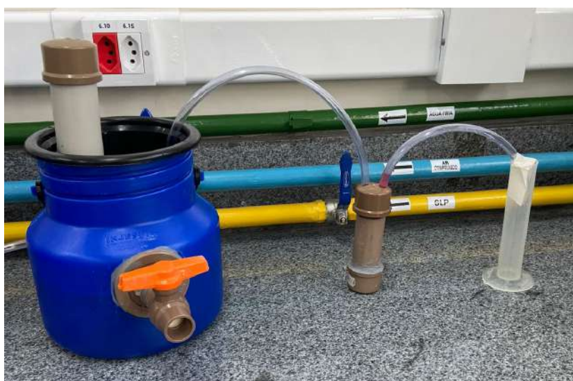
FIGURA 8 - Biodigestor e gasômetro acoplados
