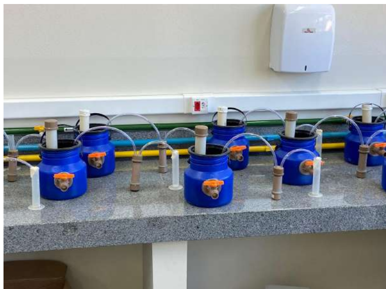
FIGURA 9 - Biodigestores montados para realização do experimento
