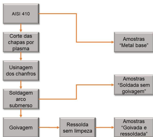
Figura 14 – Fluxograma da metodologia empregada para obtenção das amostras.
