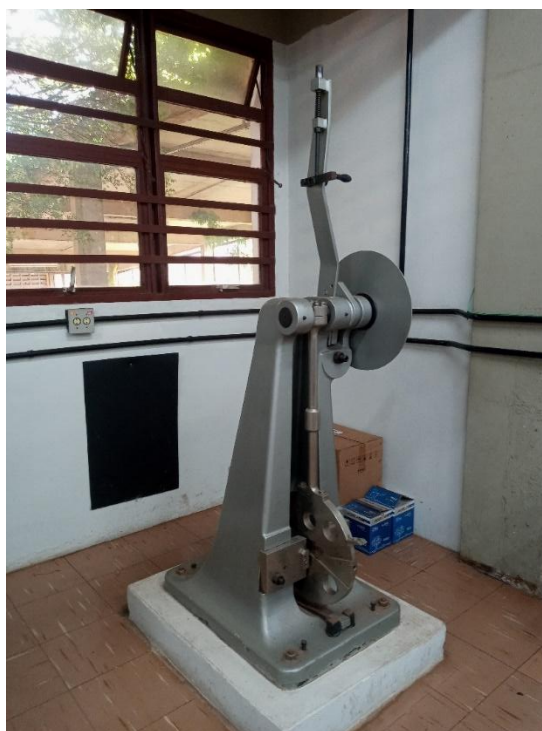
Figura 28 - Máquina para ensaio de impacto no laboratório de propriedades mecânicas do DEMa/UFSCar.
