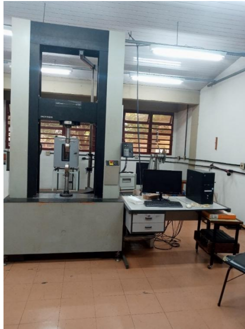
Figura 26 - Máquina de ensaio de tração utilizada no laboratório de propriedades mecânicas do DEMa/UFSCar.
