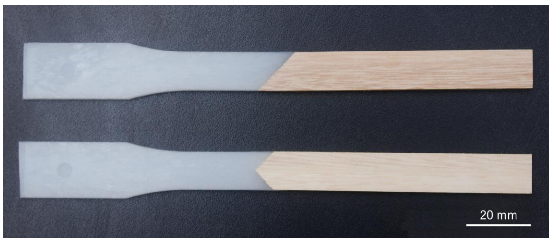
Figura 3.3: Junta híbrida polímero-madeira com geometria tipo “ scarf joint ” com chanfro simples (acima) e chanfro duplo (abaixo), adaptada da norma ASTM D638 tipo I. A espessura da junta é de 3,2 mm.
