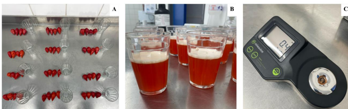
Figura 14. Etapas da preparação e análise de amostras de pimenta biquinho para determinação de sólidos solúveis (°Brix): (A) separação dos frutos; (B) amostras homogeneizadas; (C) leitura em refratômetro digital.
