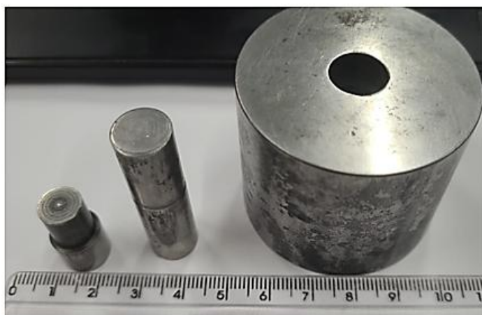
Figura 2.2 – Conjunto do molde de aço utilizado para operações de compactação.
